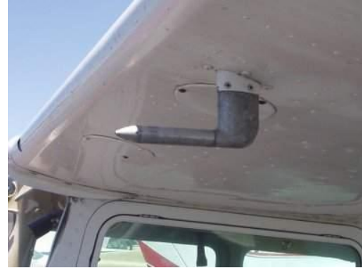
Las aeronaves utilizan tubos de pitot para medir la velocidad del aire.
